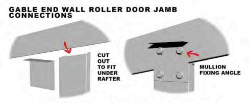
GABLE END WALL ROLLER DOOR JAMB TO RAFTER CONNECTION
